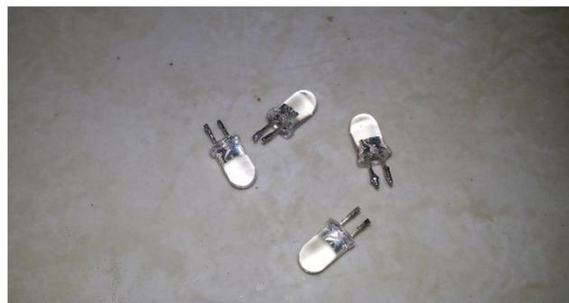
*Ilustración 113 LEDs Infrarrojos*
