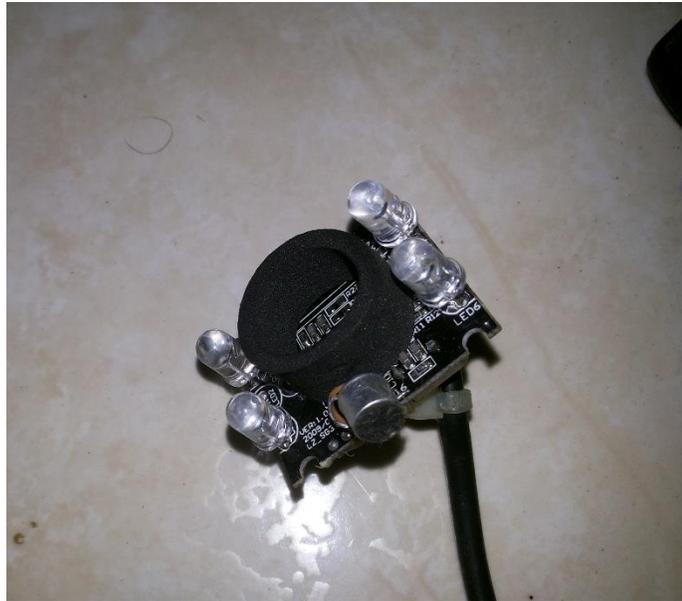
*Ilustración 115 LEDs Infrarrojos instalados*
