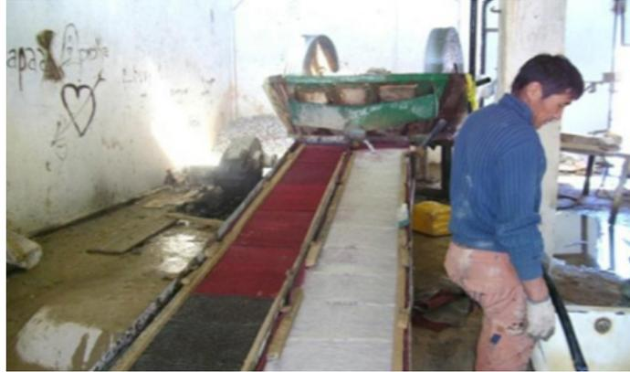
**Figura 73.** Molino de rodillos en el fondo con dos esclusas de agua y alfombras en el interior de la compañía XAMO.
