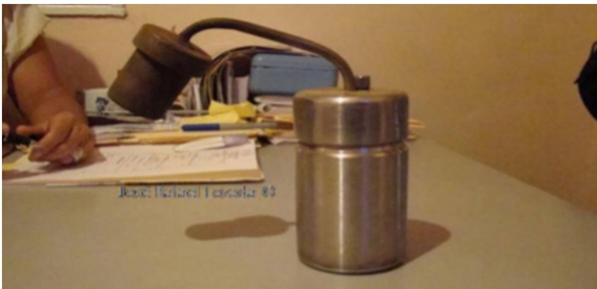
**Figura 48.** Retorta diseñada para evitar la fuga de vapores de mercurio.
