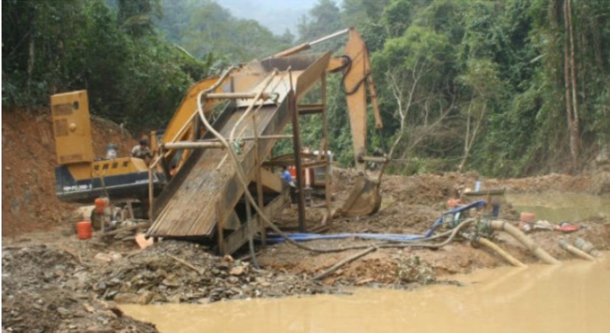
**Figura 67.** Uso de una excavadora en el río Hien, en la provincia Cao Bang, para arrancar banco de tierra y posteriormente extraer el oro.
