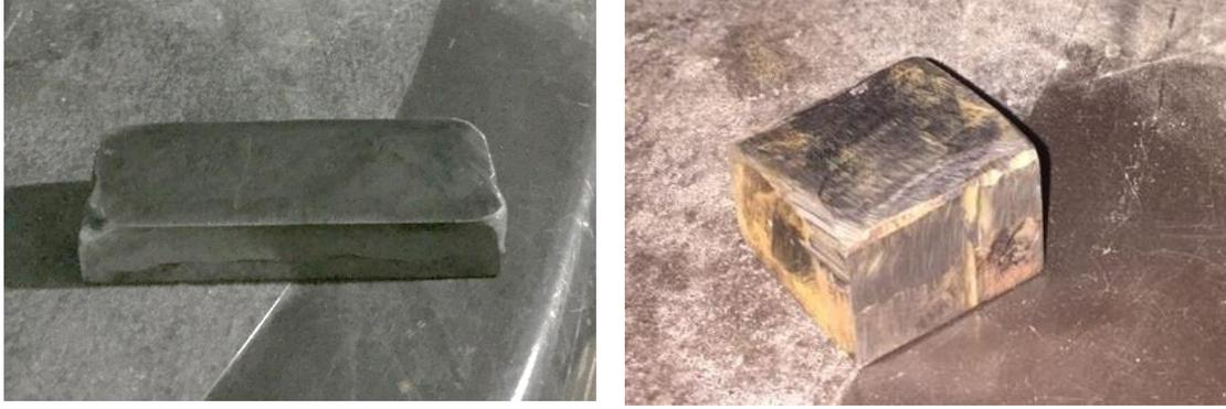
*Figura 25. Probetas preparadas para realizar ensayos de caracterización y abrasión según norma ASTM G65.*
