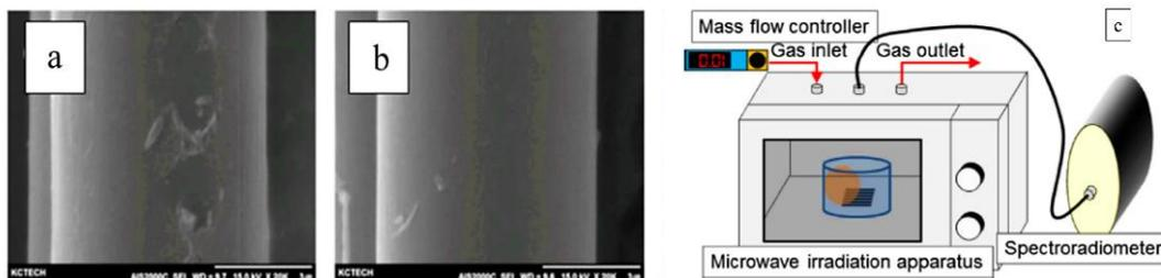
**Figura 16.** a) y b): fibras de carbono obtenidas a partir del proceso de pirólisis y c) proceso de pirólisis asistida por microondas, (Zhang et al., 2020).
