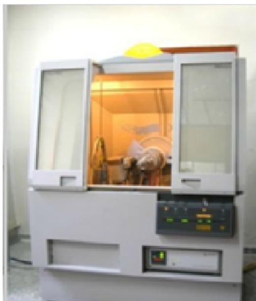
**Figura 3.7.:** Difractómetro Panalytical X'Pert Pro MPD. Tomada de la referencia [3].
