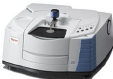
Figura 3.8.: Espectrómetro FTIR usado para la medición de los espectros. Tomada de la referencia [3].
