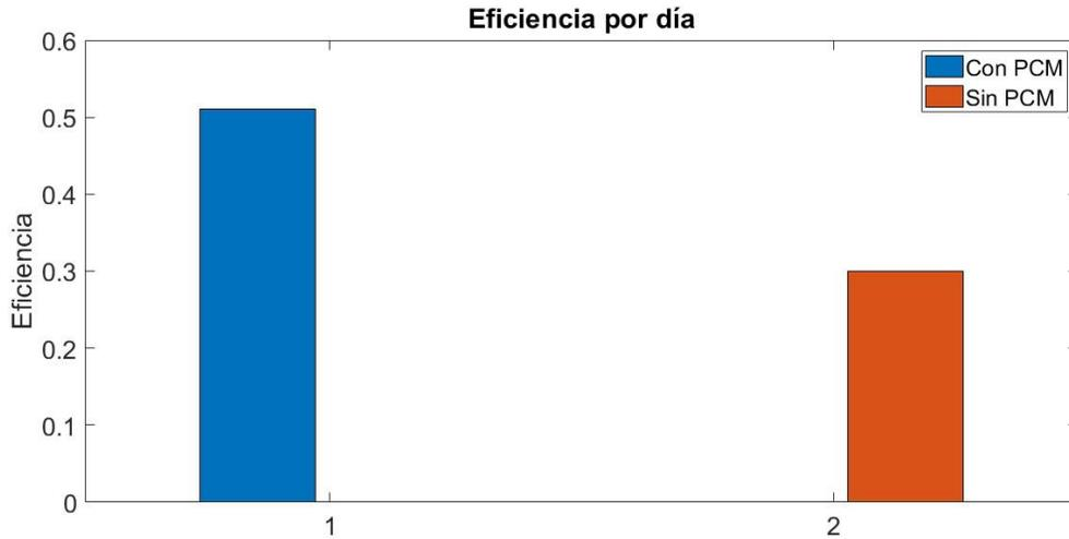
**Figura 11.** Eficiencia térmica por día para ambos colectores.
