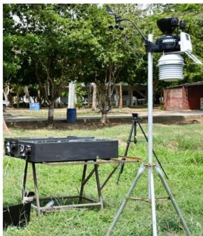
**Figura 3.** Estación meteorológica Davis Vantage Pro 2 usada para realizar mediciones de radiación solar.
