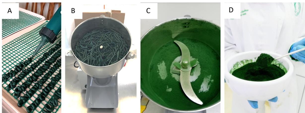
Figura 17. A) Elaboración de “churros” para secado al sol o en hornos de secado. B) Biomasa seca lista para pulverizar. C) Molienda de espirulina. D) Espirulina en polvo (Foto original Herazo-Cárdenas)
