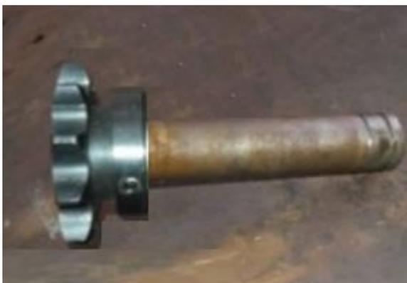
Figura 3.15 - Ensamble de los piñones en el eje de transmisión de la primera fase.
