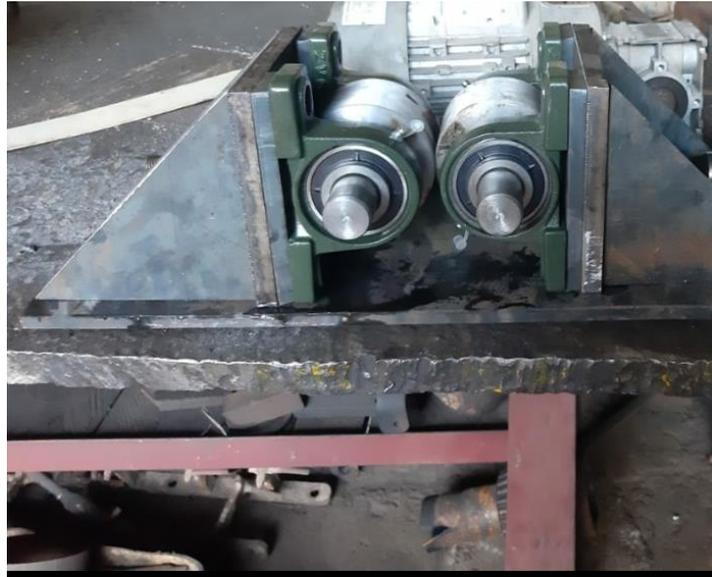
Figura 3.16 - Ensamble de los ejes de transmisión, rodamientos y piñonería en las placas laterales
