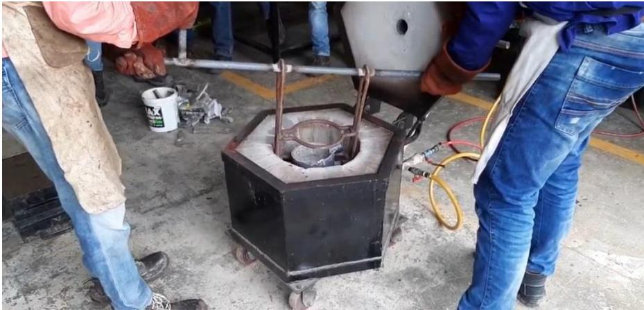
Figura 2.6 - Horno de crisol móvil para fundición
