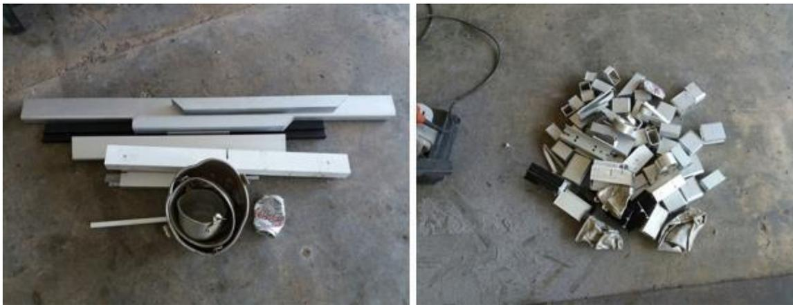
Figura 2.5 - Aluminio reciclado utilizado para fundición de probetas
