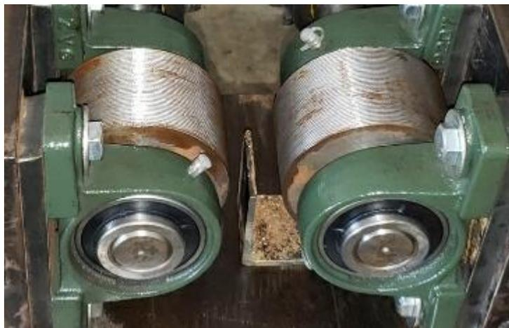
Figura 3.17 - Montaje de los rodillos de laminación
