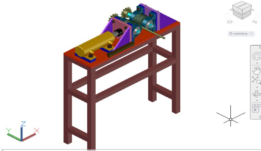
Figura 2.1 - Esquema del equipo de laminación de rosca de trabajo en frío para aluminio diseñado bajo los lineamientos de la metodología para manufactura y ensamble DFMA
