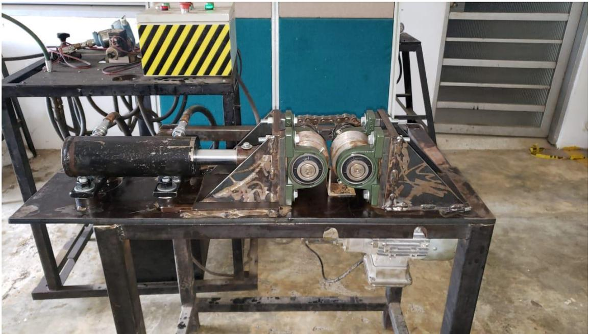
Figura 3.19 - Equipo de laminación de roscas construida
