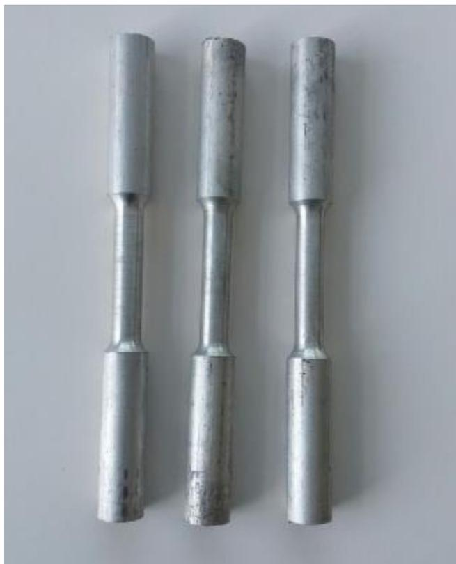
Figura 3.20 - Probetas fundidas para ensayos de tensión
