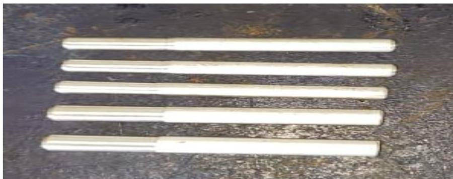
Figura 3.22 - Probetas fundidas para ensayos de laminación
