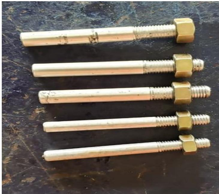
Figura 3.24 - Probetas fundidas laminadas con tuerca
