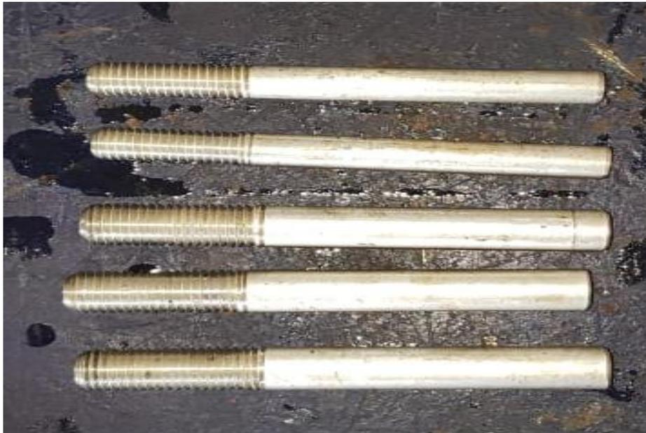
Figura 3.23 - Probetas fundidas laminadas
