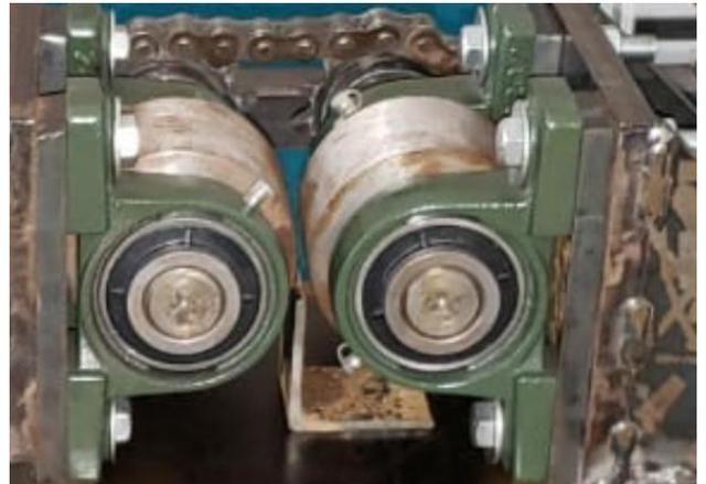
Figura 4. Rodillos de laminación.
