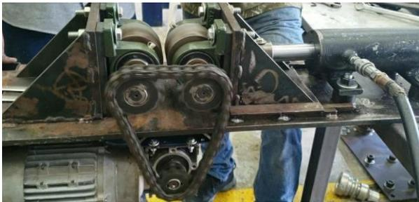
Figura 3. Configuración sistema transmisión potencia motor-cadena.
