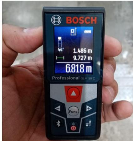
**Figura 11.** Medición de altura de descarga con medidor laser BOSCH en planta RED CÁRNICA.
