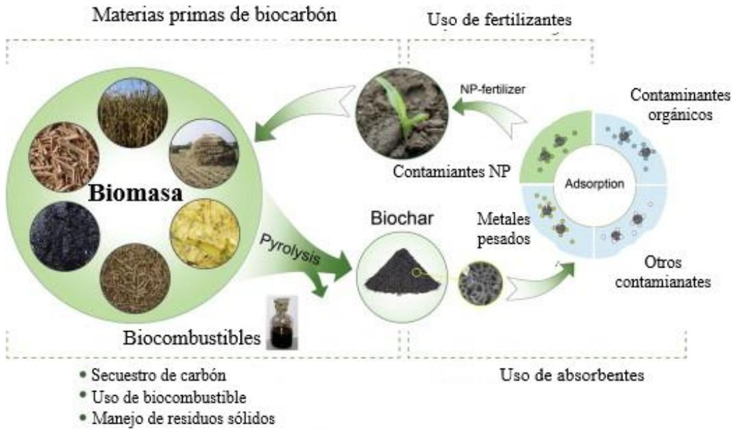
**Figura 12.** Producción y usos del biochar. Fuente (Tan et al., 2015)
