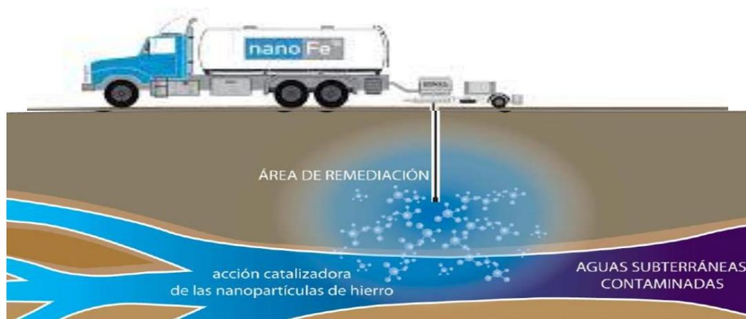
**Figura 15.** Esquema de aplicación de nanopartículas de hierro en el proceso de remediación de aguas subterráneas. Fuente: (Chatterjee et al., 2020).
