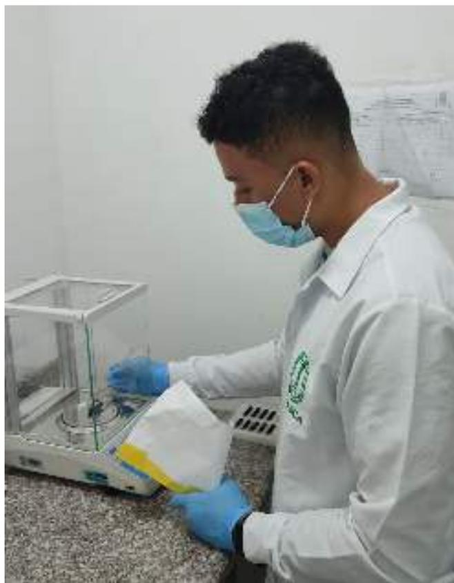
**Figura 7.** Proceso de pesado de muestra para análisis de HgT.
