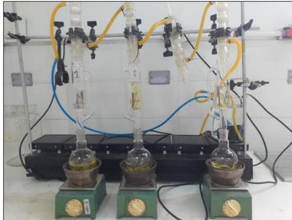
**Figura 14.** Determinación del contenido de grasa bruta del ensilaje de girasol mediante el método de Soxhlet, se observan balones de fondo plano sobre calentador con material graso extraído de las muestras distribuidas por tratamientos.
