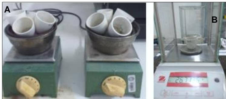
**Figura 12.** Determinación del contenido de cenizas del ensilaje de girasol. **A.** Crisoles con muestras calcinadas a 550 ° C. **B.** Calculo del peso del crisol más las cenizas utilizando balanza analítica.
