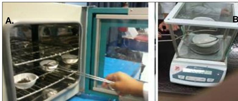
**Figura 13.** Determinación del contenido de humedad del ensilaje de girasol. **A.** Capsulas de porcelana con muestras por tratamientos en estufa a 105°C. **B.** Calculo del peso de capsulas de porcelana más muestra seca utilizando balanza analítica.
