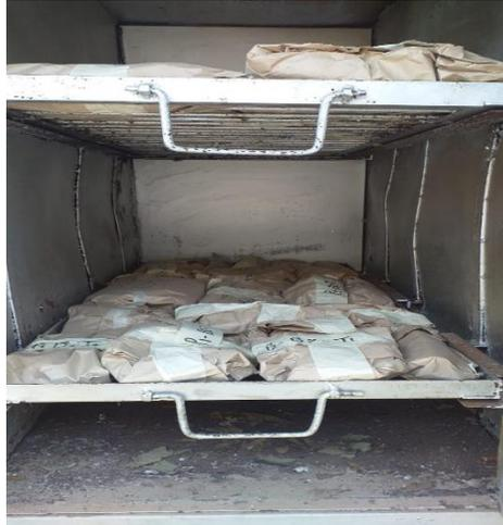
**Figura 9.** Muestras de biomasa fresca de girasol empaquetadas y rotuladas por tratamientos, bloque y el número de planta, puesta a desecar en horno de secado.
