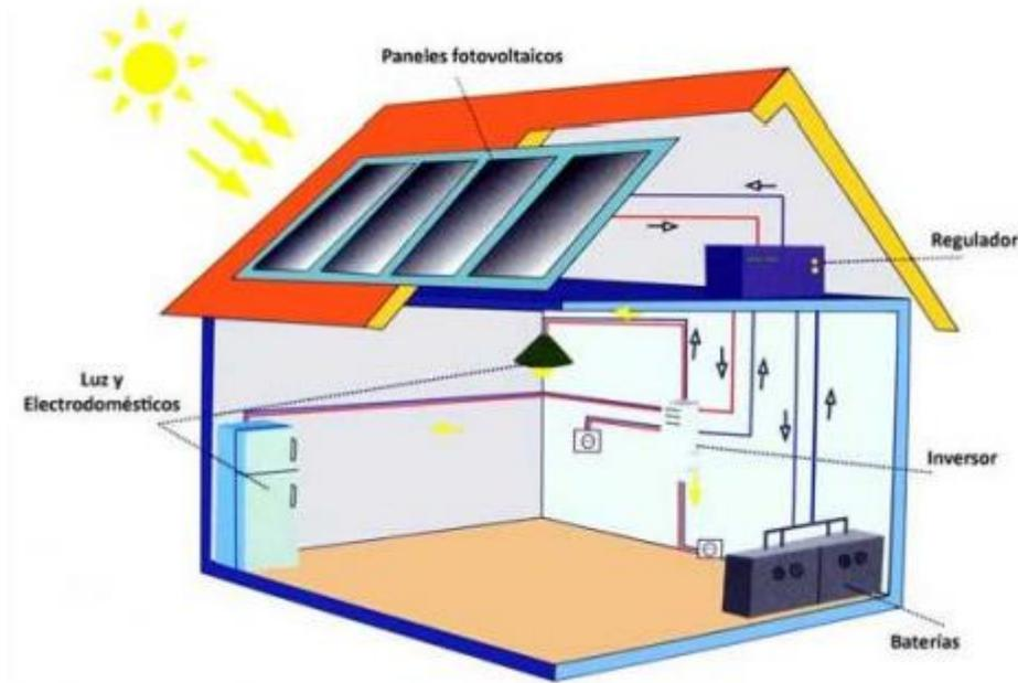
*Ilustración 5. Bosquejo del diseño del montaje de paneles solares fotovoltaicos.*
