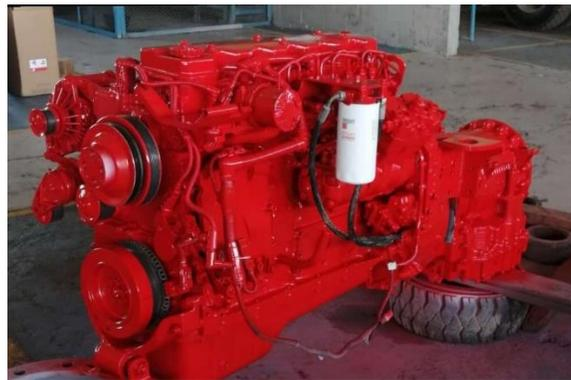
*Imagen 15. Motor Cummins QSB 6.7*
