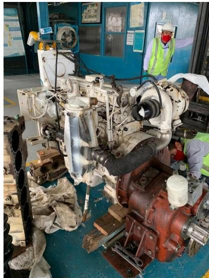
*Imagen 16. Reparación de motor y transmisión del remolcador Carepa.*
