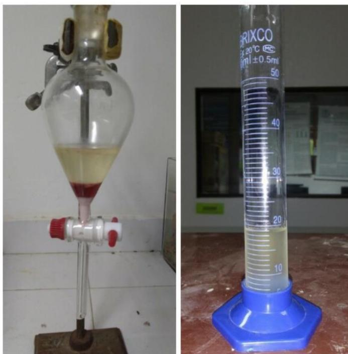
Figura 12: Separación del biodiésel y el subproducto de glicerina
