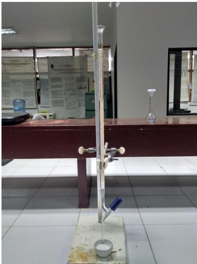
**Figura 9: Montaje de la funcionalización del catalizador con  $\text{Ca(OH)}_2$  30%**
