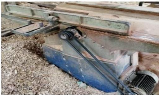
Figura 4 Canteadora marca Stanley de 5 hp modelo 1991
