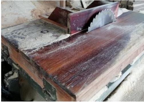
Figura 3 Cortadora industrial: Dewalt 2 hp modelo 1995
