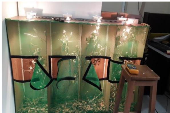
**Figura 2.** Fotografía de los carriles verticales con gradiente térmico de 18 a 34°C.
