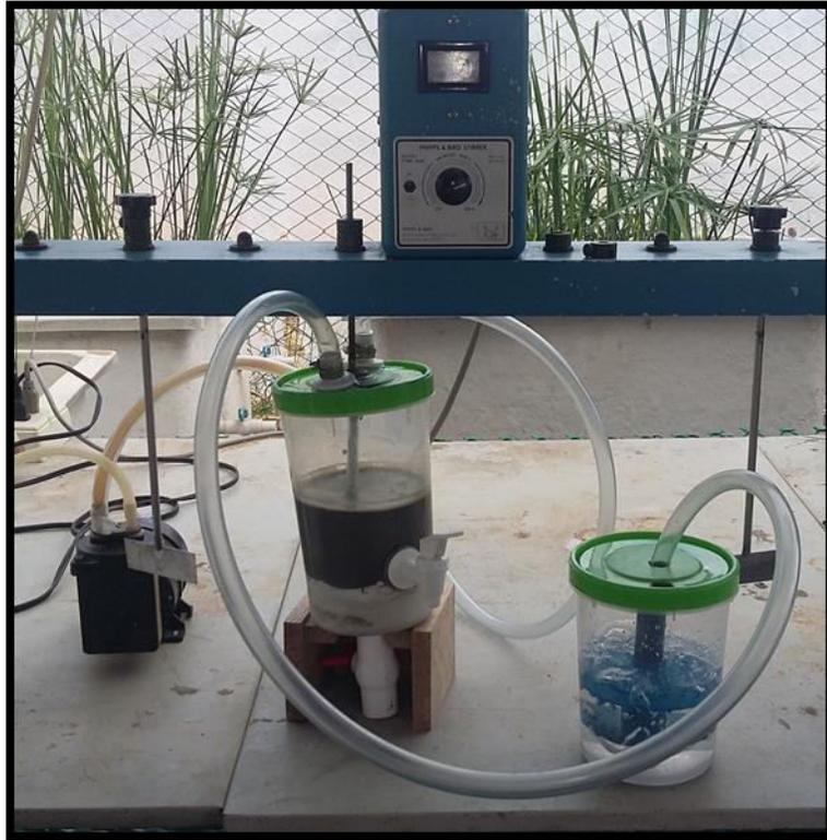
**Figura 4.** Reactor de lavado de lodos procedentes del beneficio de oro
