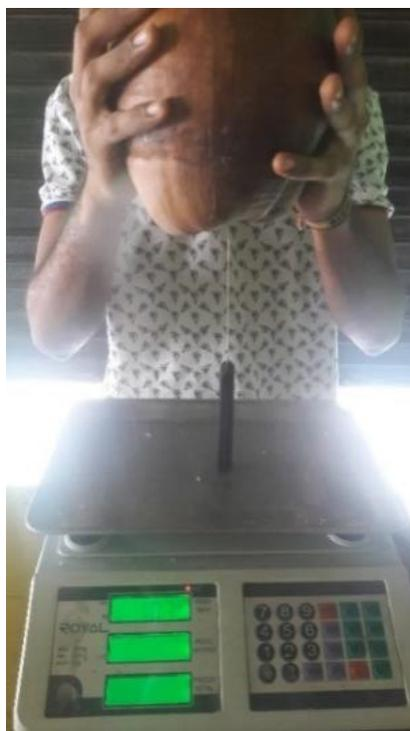
**Figura 4-5:** Montaje para determinar fuerza de penetración en la fibra. (*Fuente propia*)
