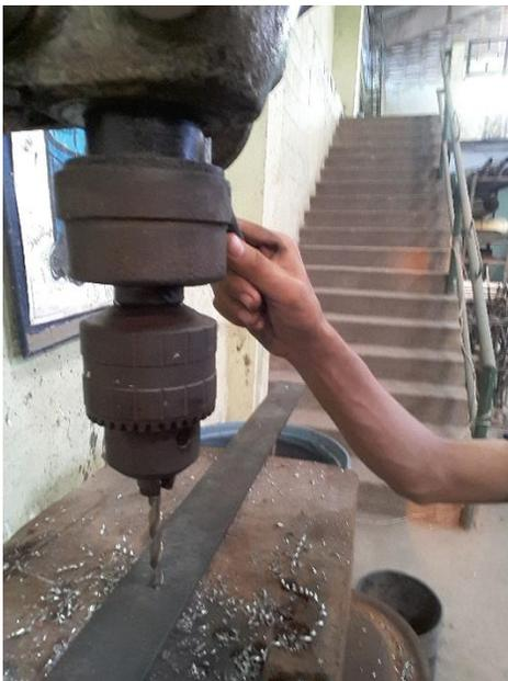
**Figura 5-34.** Proceso de perforado. (*Fuente: propia*).
