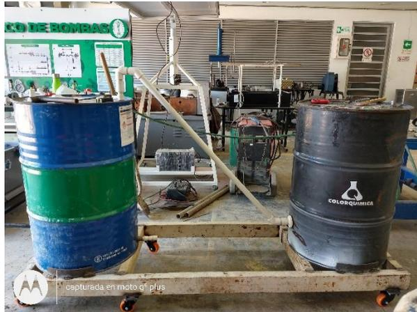
**Figura 20.** Sistema de tratamiento de gases-Estructura móvil
