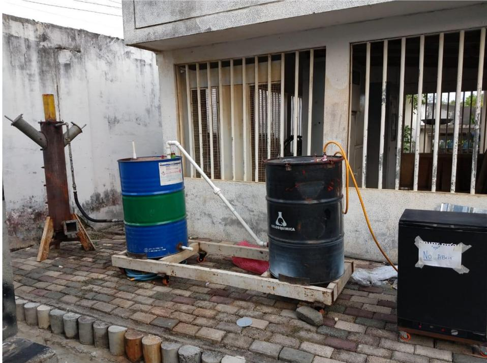
**Figura 26.** Montaje del gasificador- Equipo de lavado de Gases- Nevera
