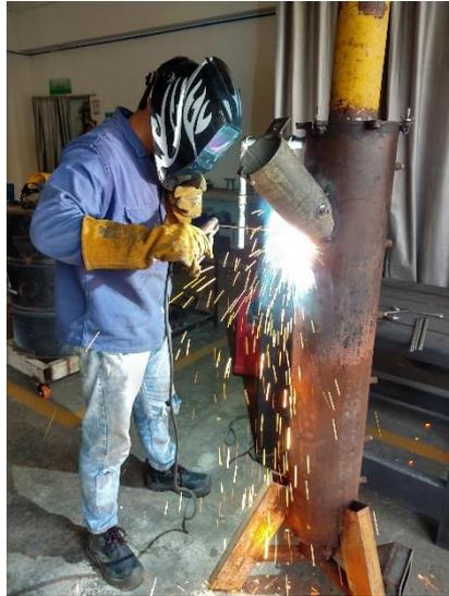
**Figura 15** .Proceso de soldadura para las tolvas
