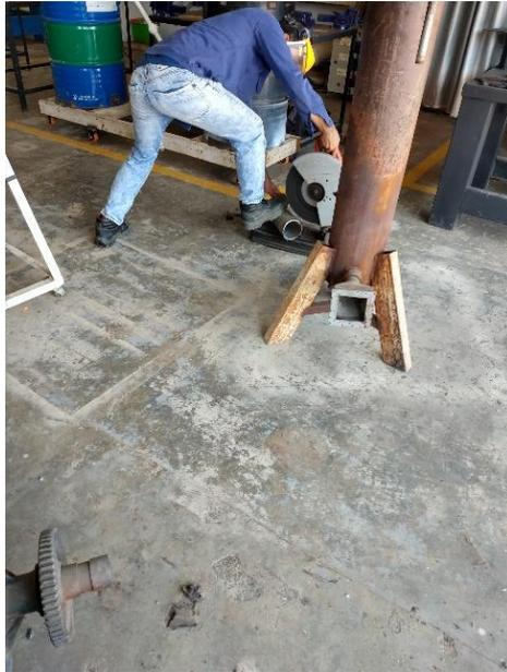
**Figura 13.** Proceso de corte de tubos a 45°
