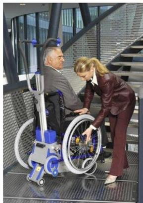
**Figura 4.** Sube Escaleras Portátil Liftkar PT Adapt, Recuperado de
