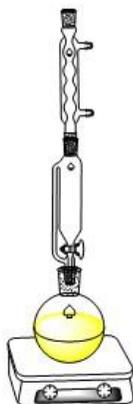
**Figura 8.** Diagrama de extracción del aceite usando el método Soxhlet
