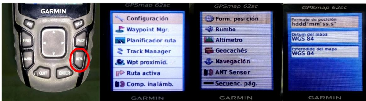
Figura 9. Configuración de formato de posición
