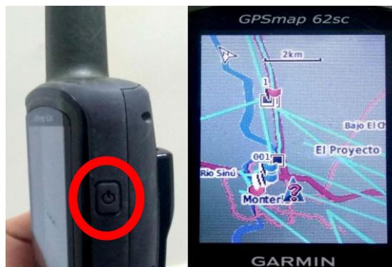
Figura 7. Método de encendido del GPS.
