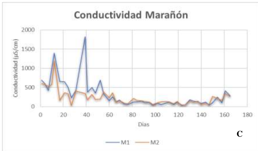
Figura 31. Comportamiento de los parámetros fisicoquímicos en los tratamientos de marañón. A. Temperatura (°C). B. pH. C. CE (µS/cm). D. POR (mV)
