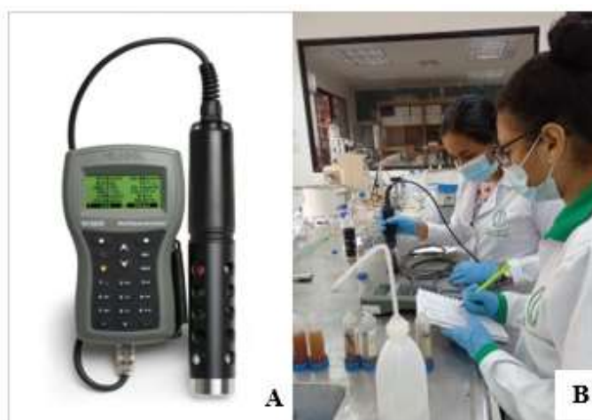
Figura 21. Medición de parámetros fisicoquímicos A Multiparámetro utilizado para medición de parámetros fisicoquímicos (HI 9829 medidor multiparámetro) B. Medición de parámetros fisicoquímicos.
