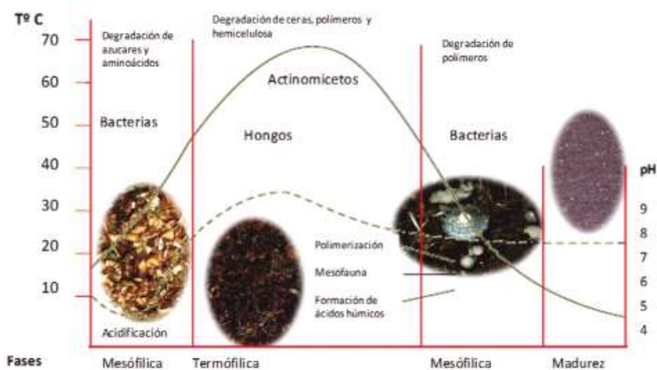
Figura 2. Variaciones de: Temperatura, oxígeno y pH en el proceso de compostaje. Fuente: (Restrepo et al., 2017) Valor agregado: Residuos orgánicos. Tomado de: https://unisarcapp.com/contenido/valor-agregado-residuos-organicos/186 .
