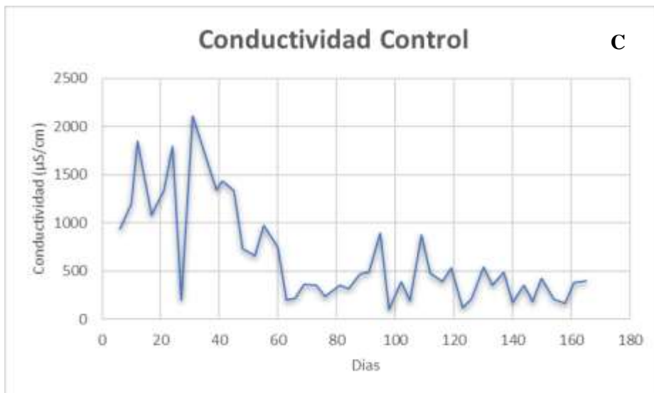
Figura 33. Comportamiento de los parámetros fisicoquímicos en el tratamiento control. A. Temperatura (°C). B. pH. C. CE (µS/cm). D. POR (mV)
