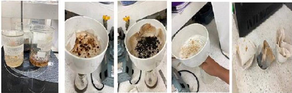
Figura 23. Contenido de alfa celulosa de las maderas de Samanea saman , Quercus robur y Tectona grandis .
