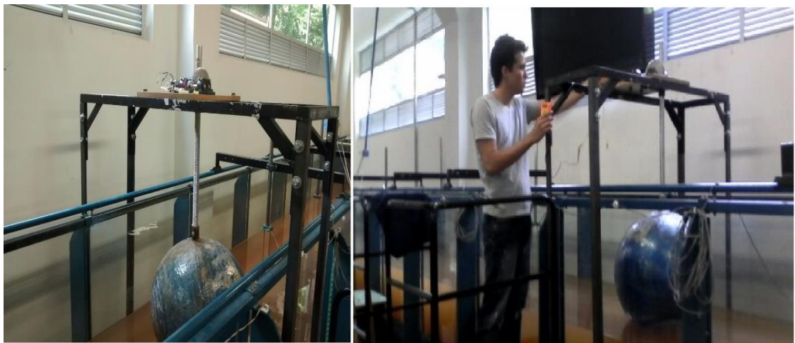
Figura 24: En la izquierda: Acople del sistema mecánico con la estructura soporte y con la boya. En la derecha: Conexión del circuito eléctrico y del multímetro.
