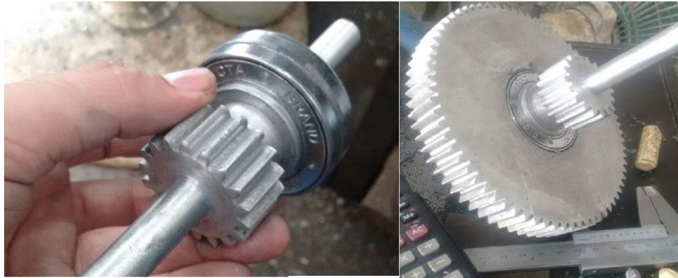
Figura 40: Embrague unidireccional o piñón libre elegido para transformar el movimiento rotativo alternativo a unidireccional y su adaptación al dispositivo Fuente: autores
