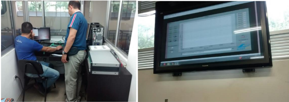
Figura 26: En la izquierda: Cabina de control del canal de oleaje. En la derecha: foto del software que controla el canal de oleaje.
