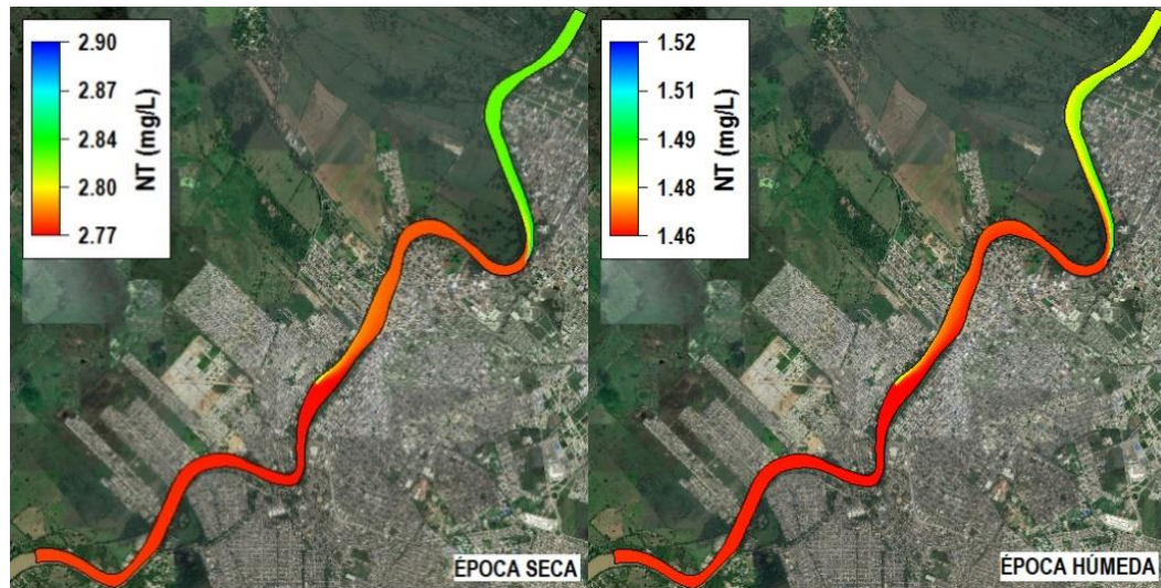
Figura 13. Resultados de simulación de NT en épocas seca y húmeda. Nótese el cambio de escala en las figuras.
