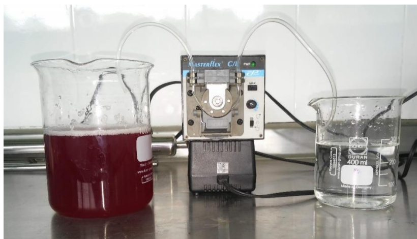
Figura 5. Montaje de la elaboración de cápsulas de corozo
