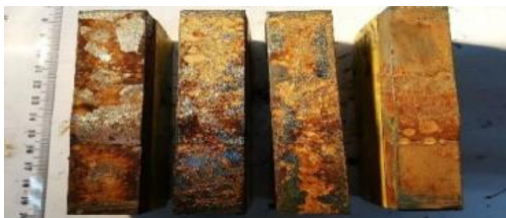
Figura 21. Inspección visual del avance del proceso de corrosión
