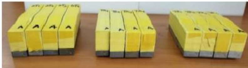
Figura 19. Protección de áreas sin contacto.
