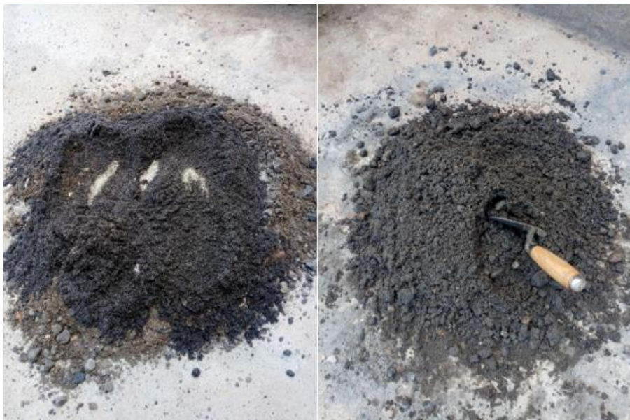
Figura 5.8: Proceso de mezclado de los agregados del concreto con adición de RHA.
