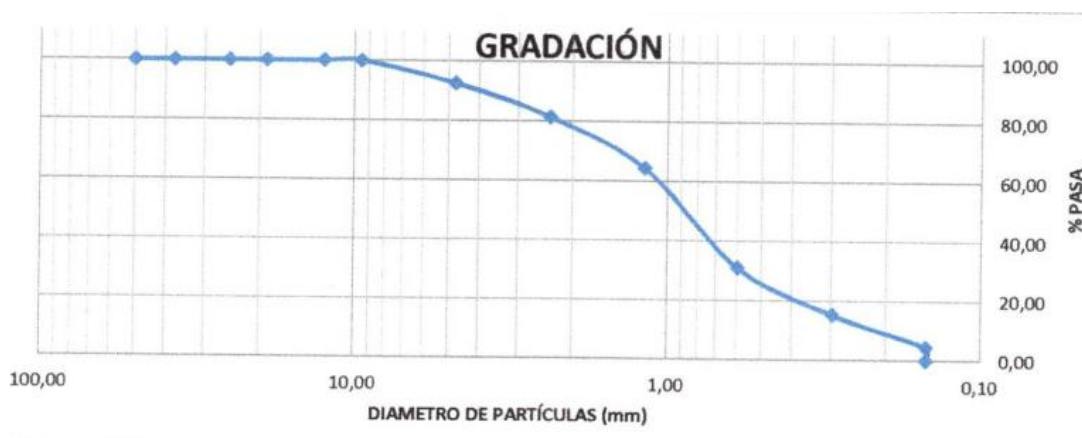
Figura 5.3: Curva granulométrica del agregado fino usado en la fabricación de las probetas de concreto con RHA.
