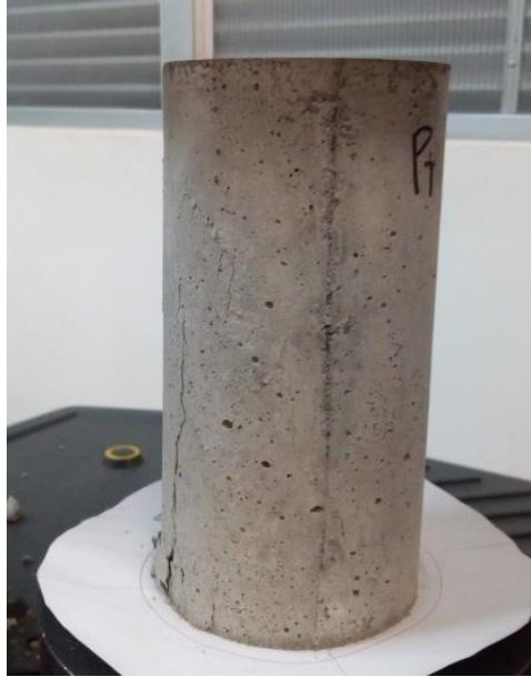
Figura 5.15: Falla tipo 2, presentada en una probeta con 10% de adición de ceniza.
