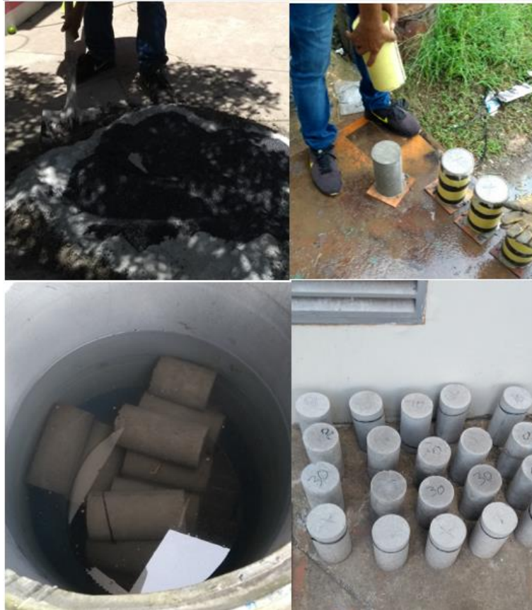
Figura 5.9: Proceso de fabricación de las probetas, desmonte y curado en agua.
