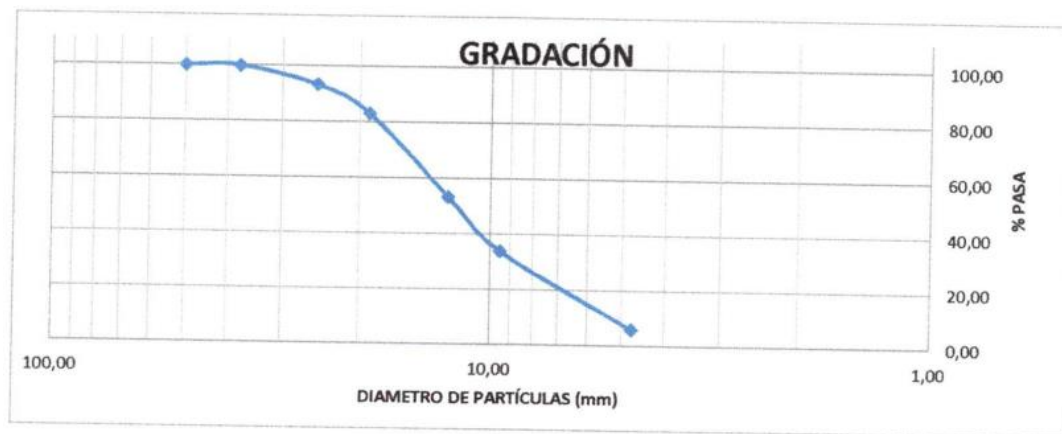
Figura 5.4: Curva granulométrica del agregado grueso usado en la fabricación de las probetas de concreto con RHA.
