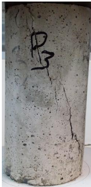
Figura 5.17: Falla tipo 4, presentada en una probeta con 30% de adición de ceniza.
