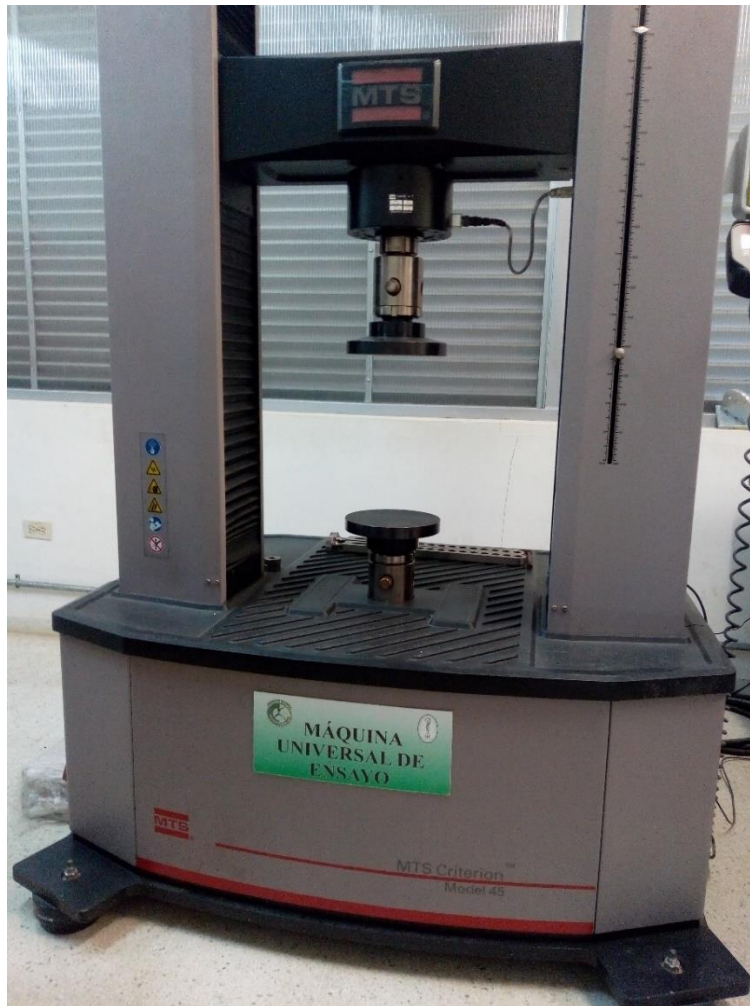
Figura 4.9: Máquina universal de ensayos MTS Criterion modelo 45, con capacidad máxima de carga de 300 kN.
