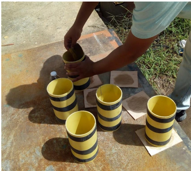
Figura 4.7: Moldes cilíndricos en PVC usados en la fabricación de las probetas.
