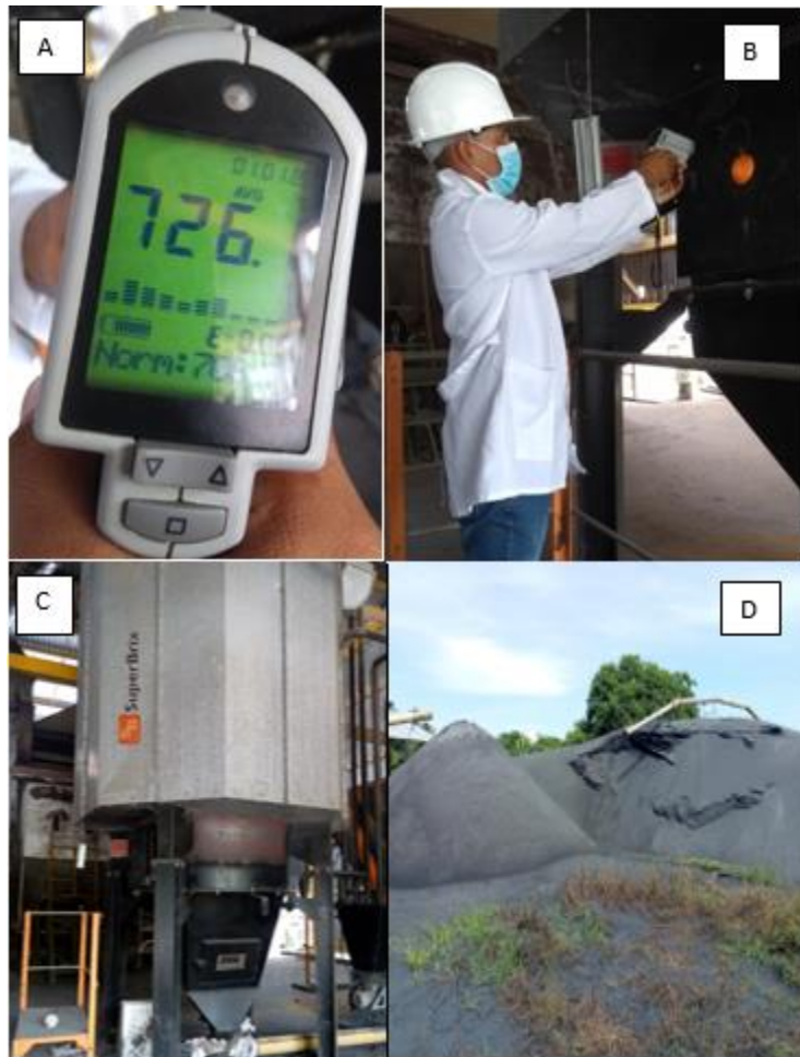
Figura 4.1: A) Pirómetro óptico. B) Medición de la temperatura con pirómetro óptico. C) Horno incinerador industrial SuperBrix modelo TEO IV 3000. D) Lugar de almacenamiento de la RHA en planta.
