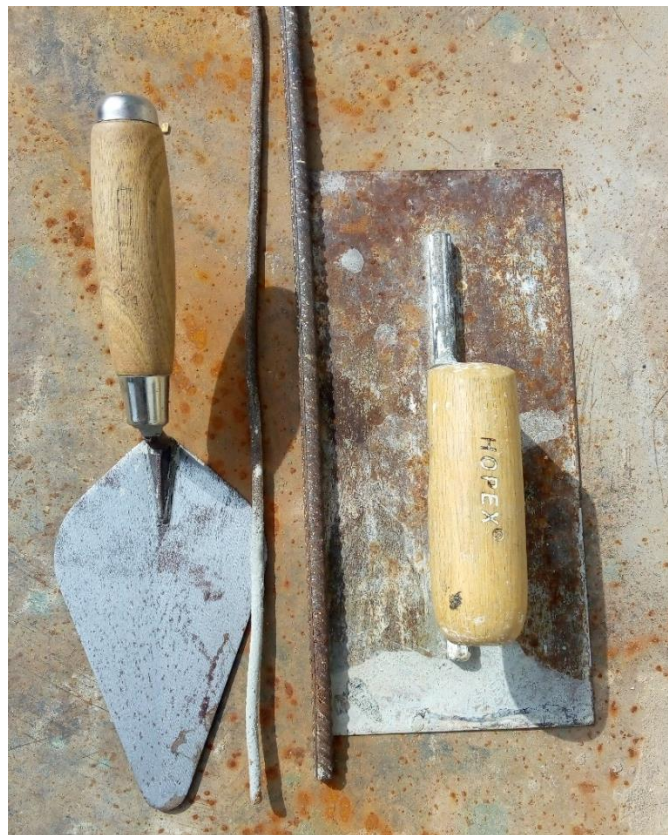
Figura 4.8: Herramientas (palaustre, llana y varilla de acero) utilizadas durante la preparación y desarrollo de las probetas.
