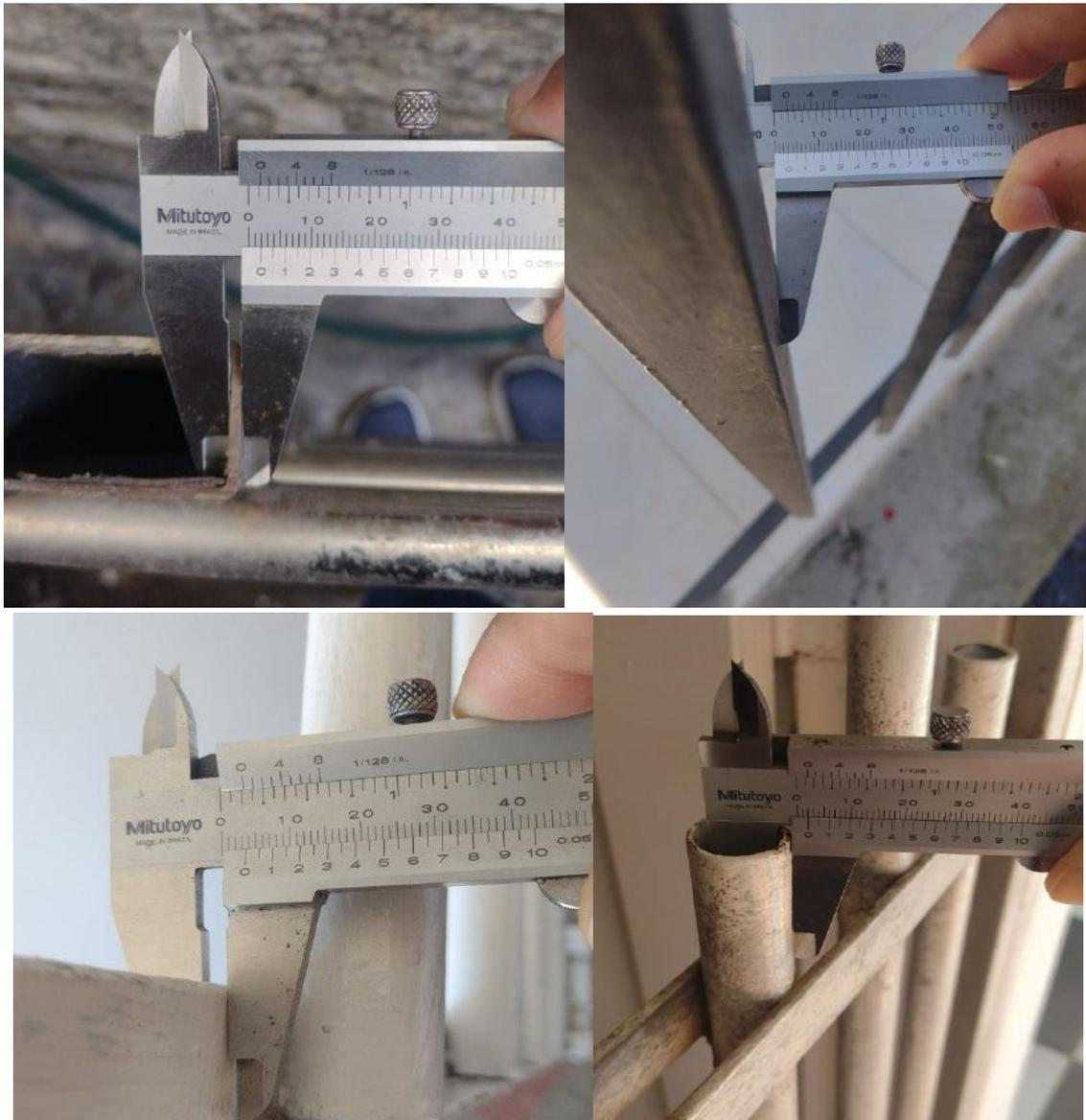
Figura 3. Espesores de materiales para ensambles de estructuras ornamentales
