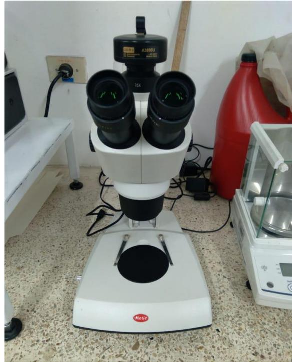
Figura 11. Estereoscopio SMZ 171 T
