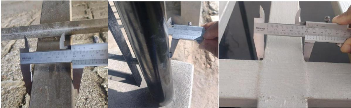
Figura 4. Dimensiones materiales de ensamble estructuras de ornamentación
