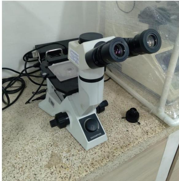
Figura 12. Microscopio óptico Olympus PME3B
