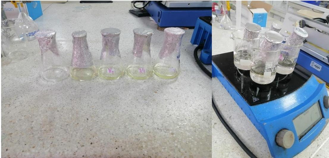
**Figura 6:** Determinación de índice de saponificación
