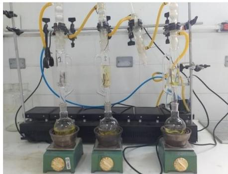
**Figura 8:** Proceso de obtención de extracto etéreo.
